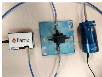
图 16 液体吸光度测量系统实物图
