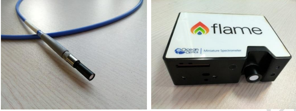
图 10 余弦校正器与光纤的连接 图 11 余弦校正器与 Flame 光谱仪的连接
