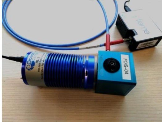
图 7 FOIS 积分球绝对辐射校准
