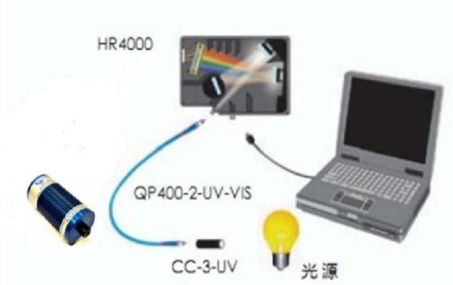
图 2 CC-3 余弦校正器绝对辐射：辐射度、光度测量系统配置图
