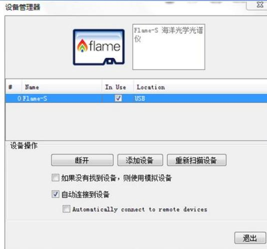
4. 调整好硬件配置后，在软件中设置数据采集参数，包括积分时间(integration time)和平均次数(average)。滑动平均(boxcar)设置为0。
